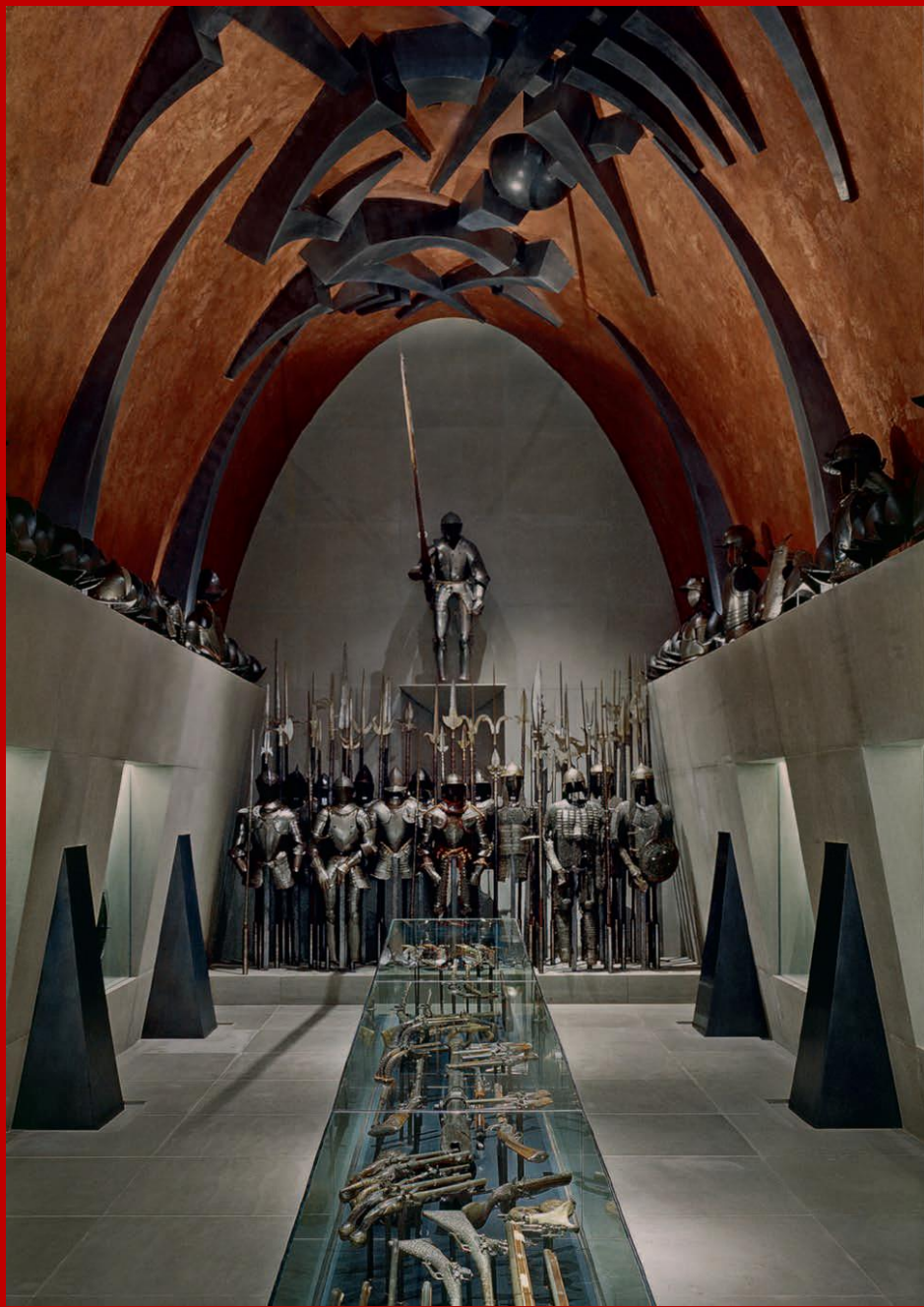
Solo tre materiali: pietra serena tagliata a sega (antiriflesso), piombo («contrafforti») e fibra di vetro (elementi del soffitto)
