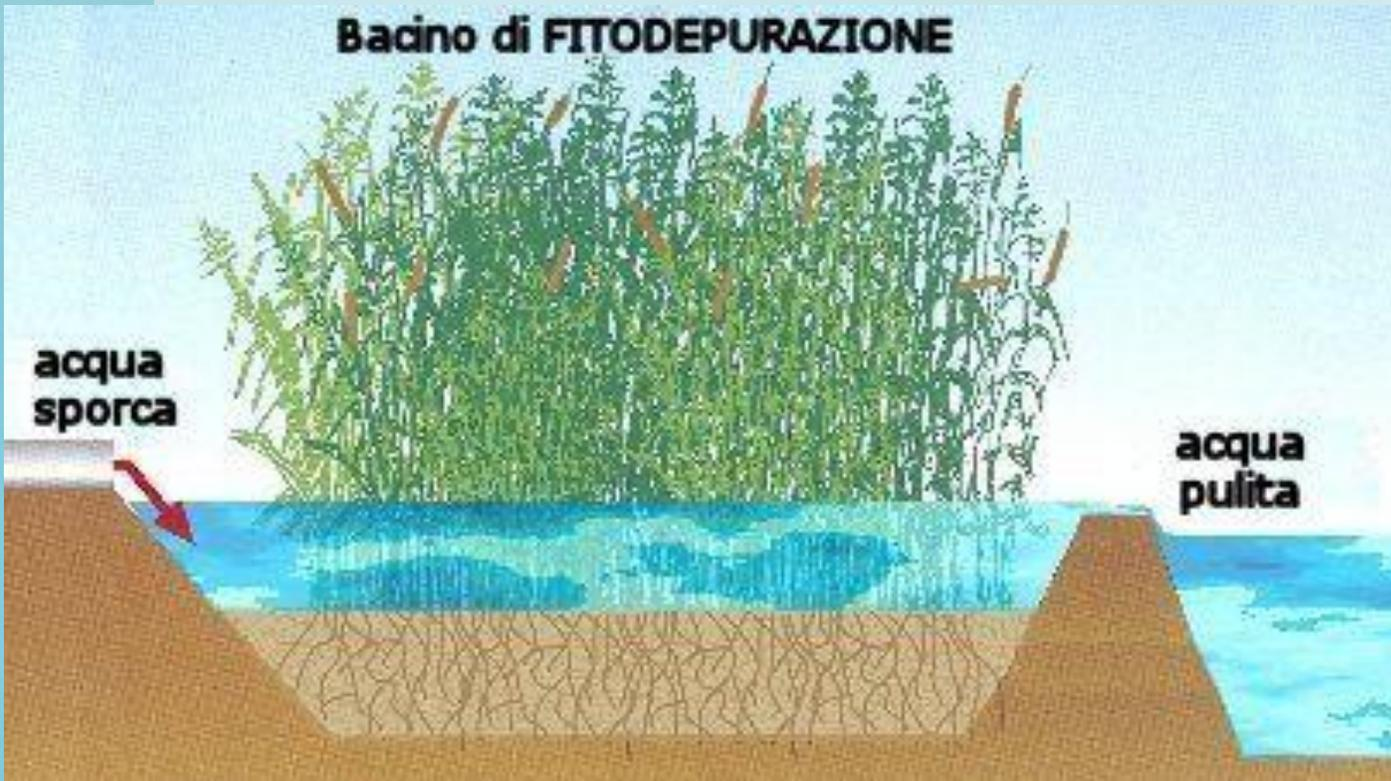
Un sistema di depurazione delle acque reflue ecologico: l'impianto di **fitodepurazione** attraverso le piante depura l'acqua di scarico.
