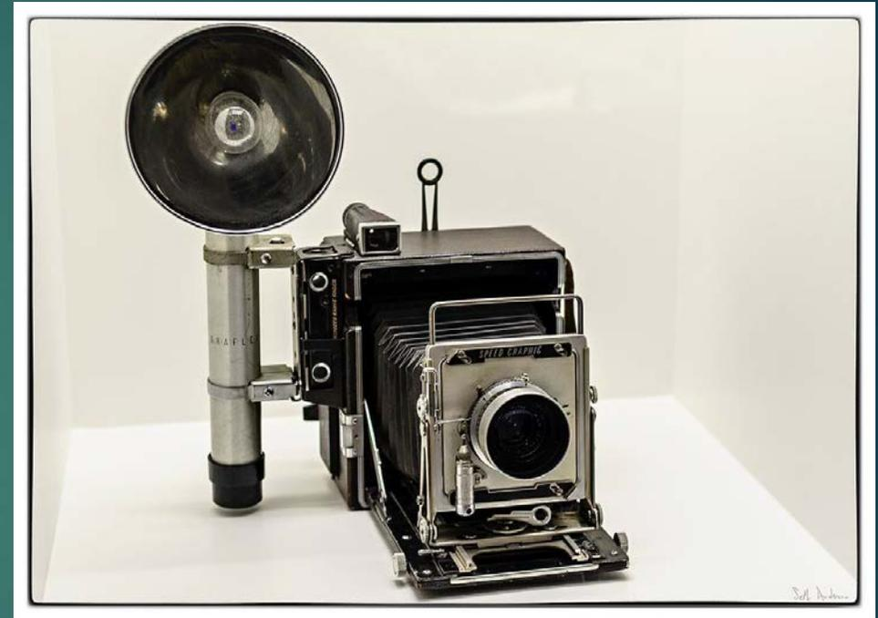
**Graflex Speed Graphic con flash montato, modello press camera usato tra i primi decenni del XX secolo — compatibile con lampadine flash a bulbo sincronizzate al ritardo della tendina**
